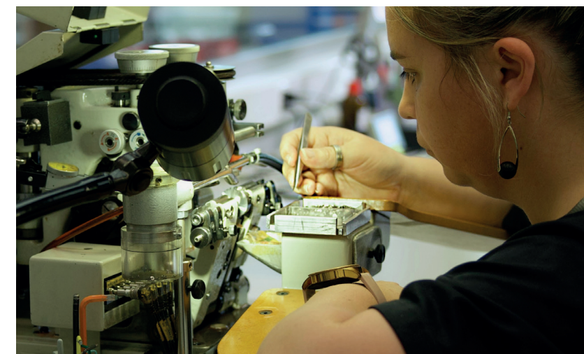
Le roulage a pour but de réduire l'usure due au frottement dans les mouvements de montres en garantissant les dimensions, les états de surfaces et la dureté des pièces.
