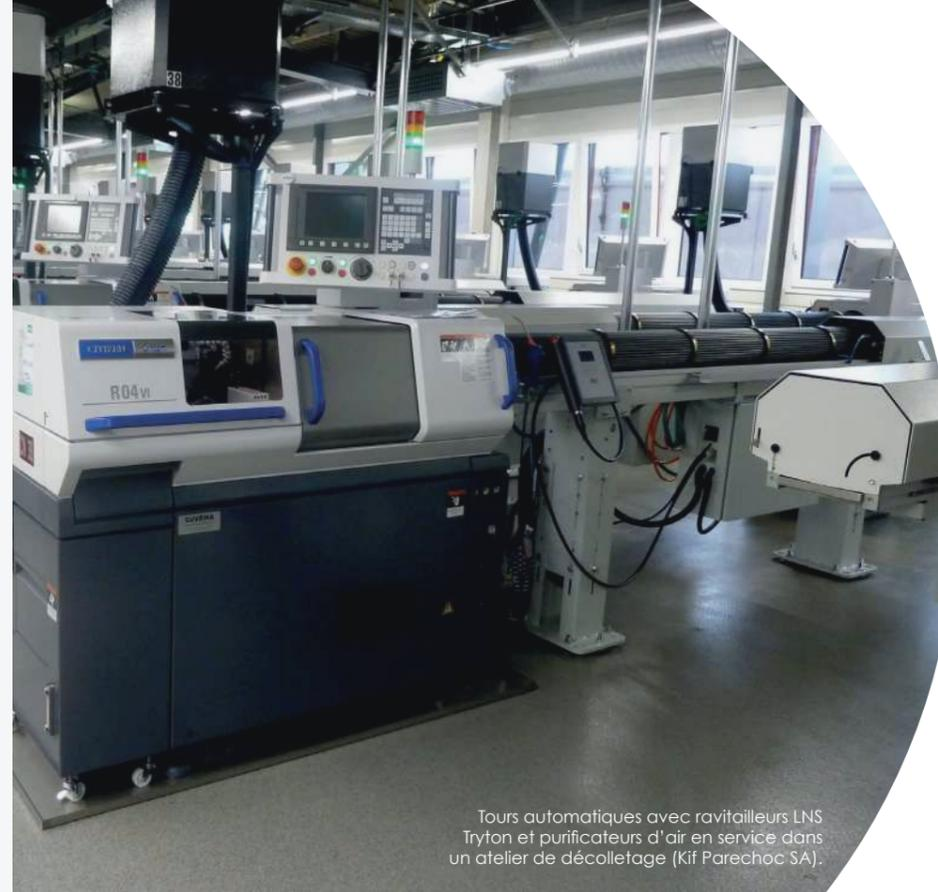
Tours automatiques avec ravitailleurs LNS Tryton et purificateurs d'air en service dans un atelier de décolletage (Kif Parechoc SA).
