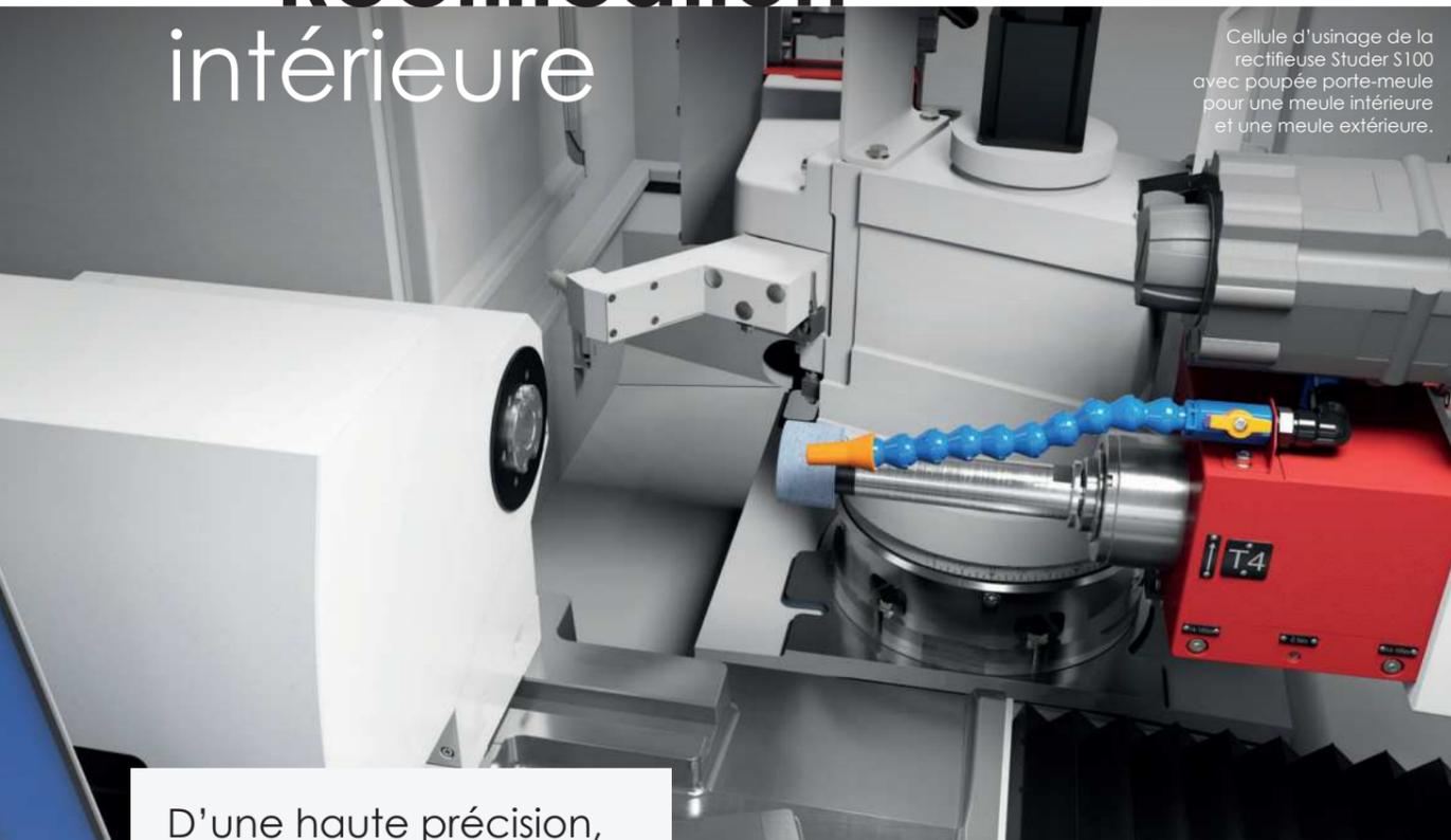
Cellule d'usinage de la rectifieuse Studer S100 avec poupée porte-meule pour une meule intérieure et une meule extérieure.
