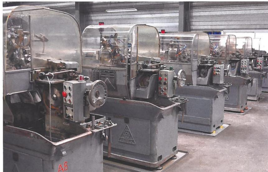
Dans les anciens tours à cames, les mouvements des outils étaient générés par des cames disposées sur un arbre à cames.
