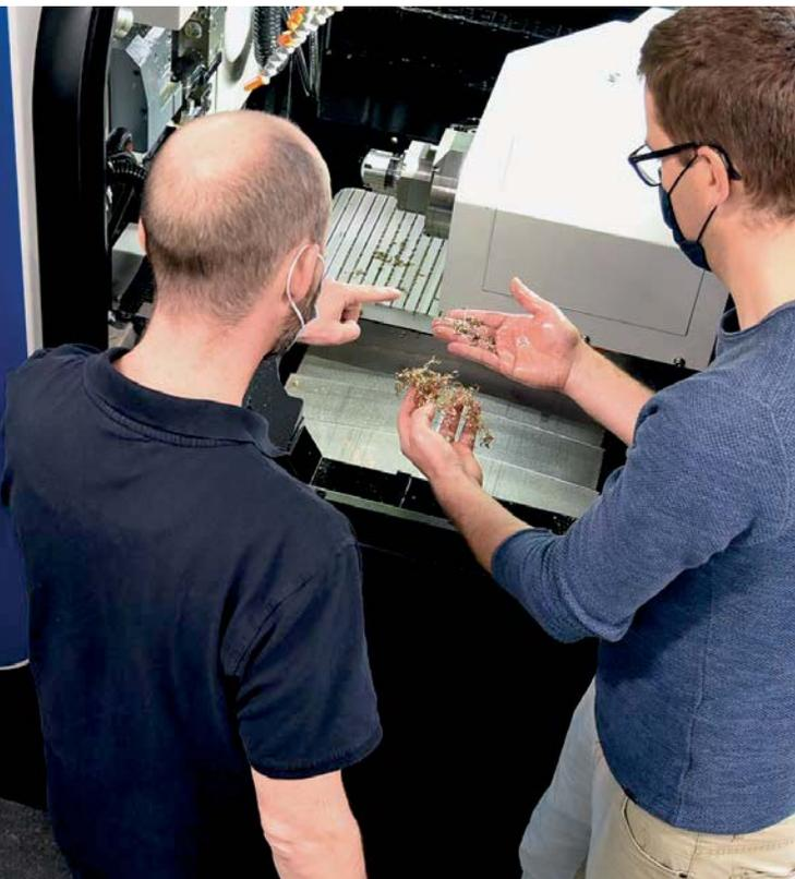
basses. Ce système unique en son genre permet aux axes longitudinaux de vibrer de manière synchrone avec la broche de la machine. Cette action engendre une brève interruption de la coupe qui permet d'expulser le copeau de manière contrôlée, en d'autres termes il est possible ni plus ni moins de gérer « la production de copeaux ». Le laiton sans plomb étant moins facile à usiner, ce genre de système prend tout son sens dans le cadre de ces travaux.
